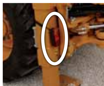
Задние дорожные огни могут устанавливаться на опорах стабилизатора при движении, а также на кабине при копании, обеспечивая максимальную видимость и защиту
