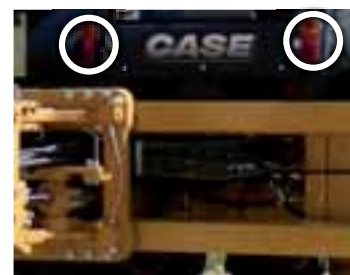
Задние дорожные огни могут устанавливаться на опорах стабилизатора при движении, а также на кабине при копании, обеспечивая максимальную видимость и защиту
